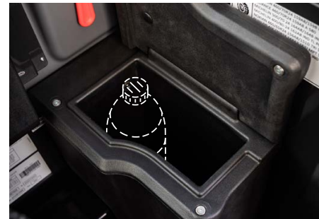
Svlačivý box s funkcí vytápění a chlazení vyrobený tak, aby se do něj vešla 1,5l láhev a svačina
