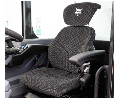
Grammer Maximo vyhříváné a vzduchem odpružené sedadlo s levou loketní opěrkou a pravou loketní opěrkou s joystickem
