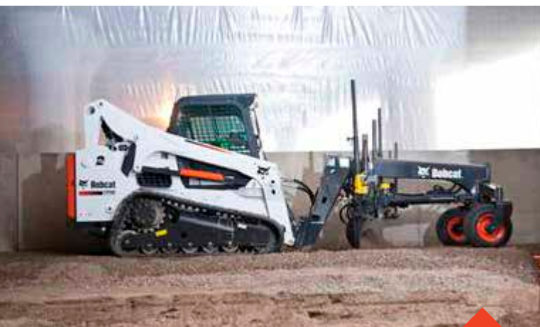
Rovně, laserem naváděné srovnávání terénu s jednou nebo dvěma rovinami sklonu.
