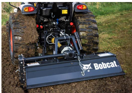
Zadní vývodový hřídel s optimalizovanými 540 ot./min. poskytuje maximální účinnost a konektivitu. Standard pro všechny modely.
